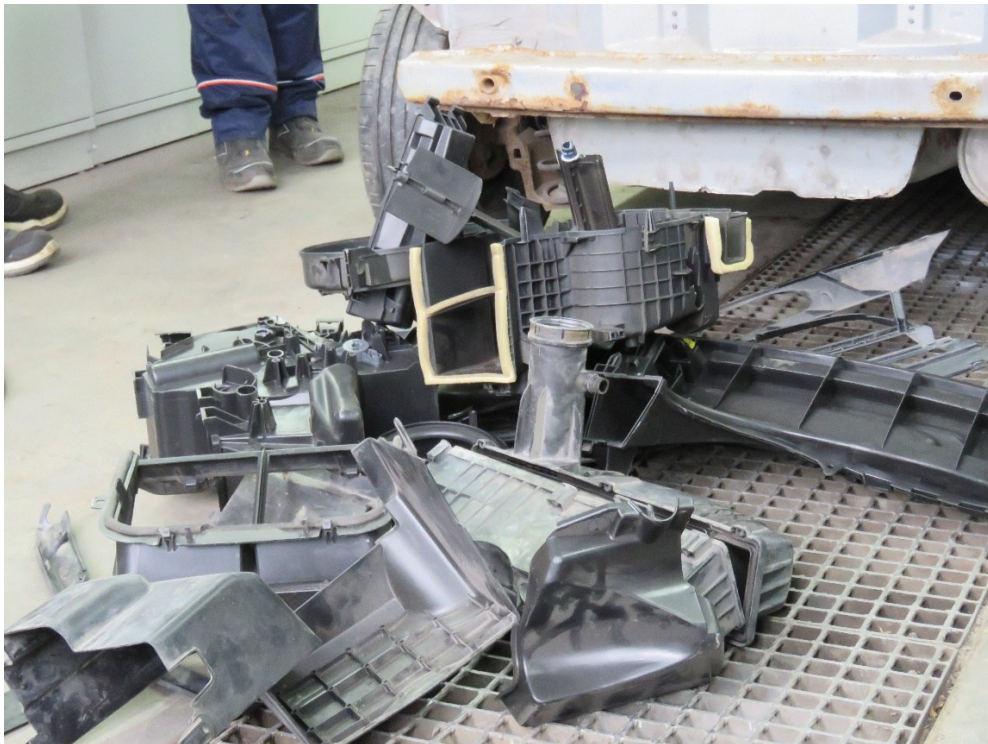
Kuva 3. PE-MD-muovityyppiä käytetään runsaasti verhoilussa. MD-merkintä voi viitata joko tiheyteen (medium density) tai mineraalitäytteiseen polyeteeniin.
