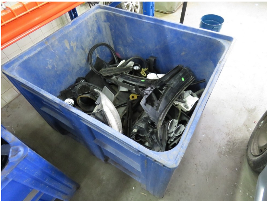
Kuva 7. Kierrätyksen ulkopuolelle jätetyt elastomeerit ja vaahdotetut polymeerit sekä monimateriaaliosia, joissa niitä on.
