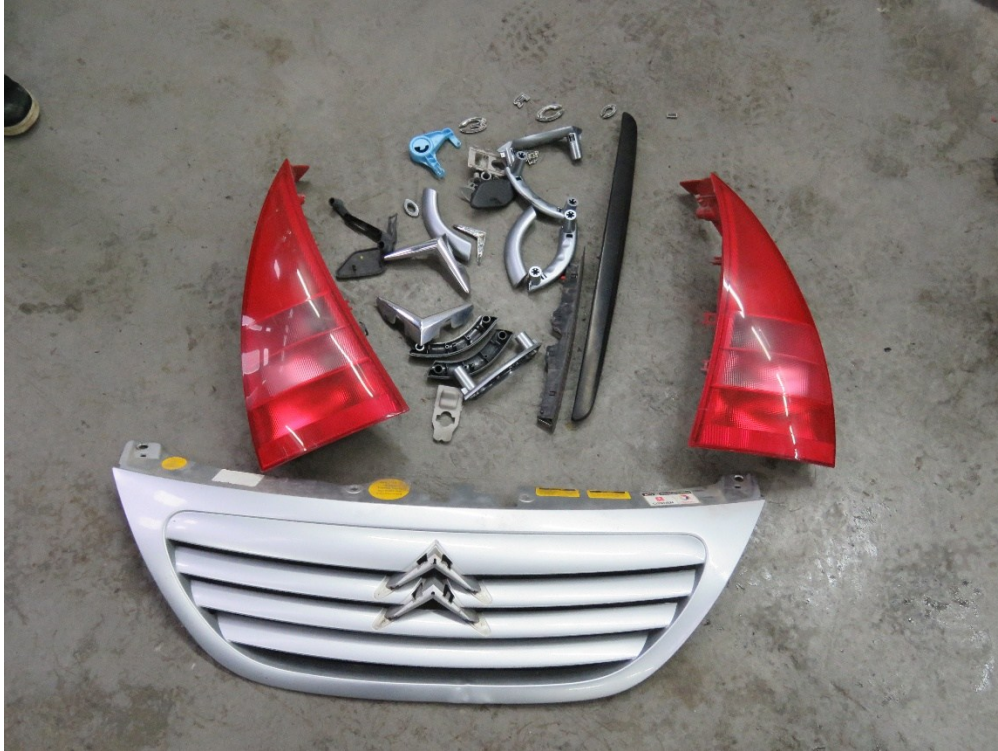
Kuva 6. PC ja ABS-muoviosia.
