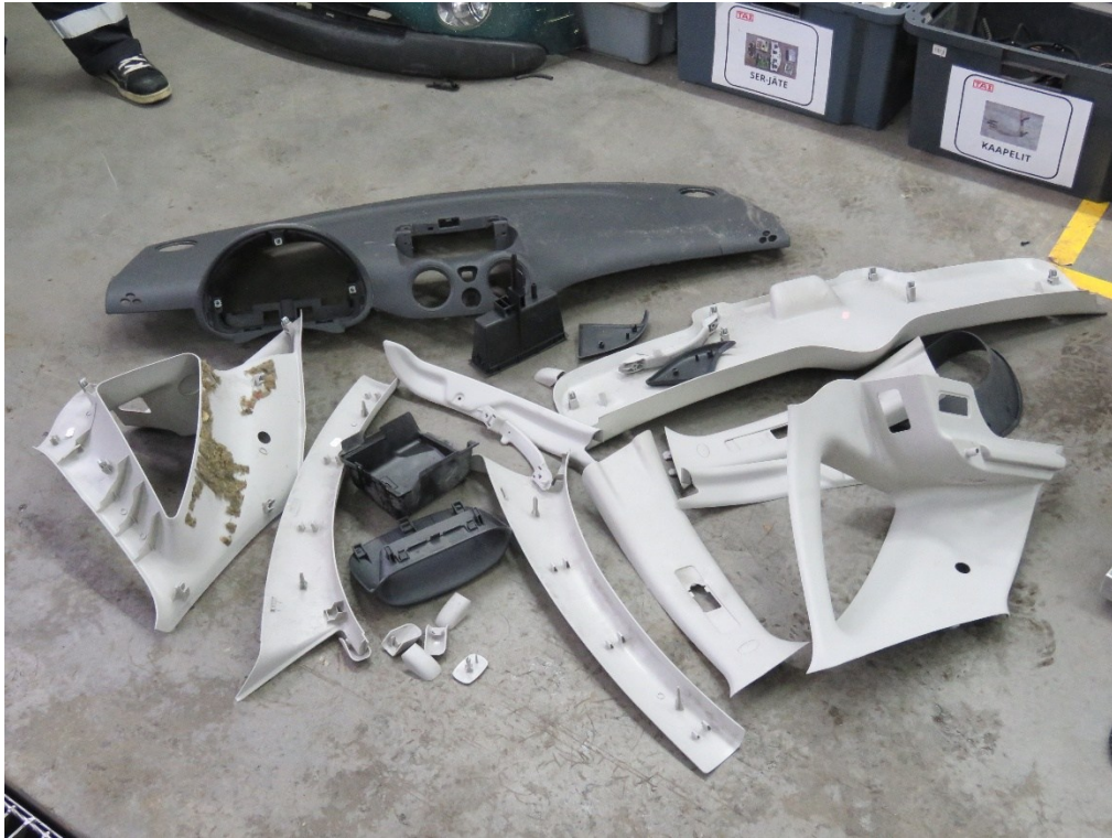
Kuva 3. PE-MD-muovityyppiä käytetään runsaasti verhoilussa. MD-merkintä voi viitata joko tiheyteen (medium density) tai mineraalitäytteiseen polyeteeniin.
