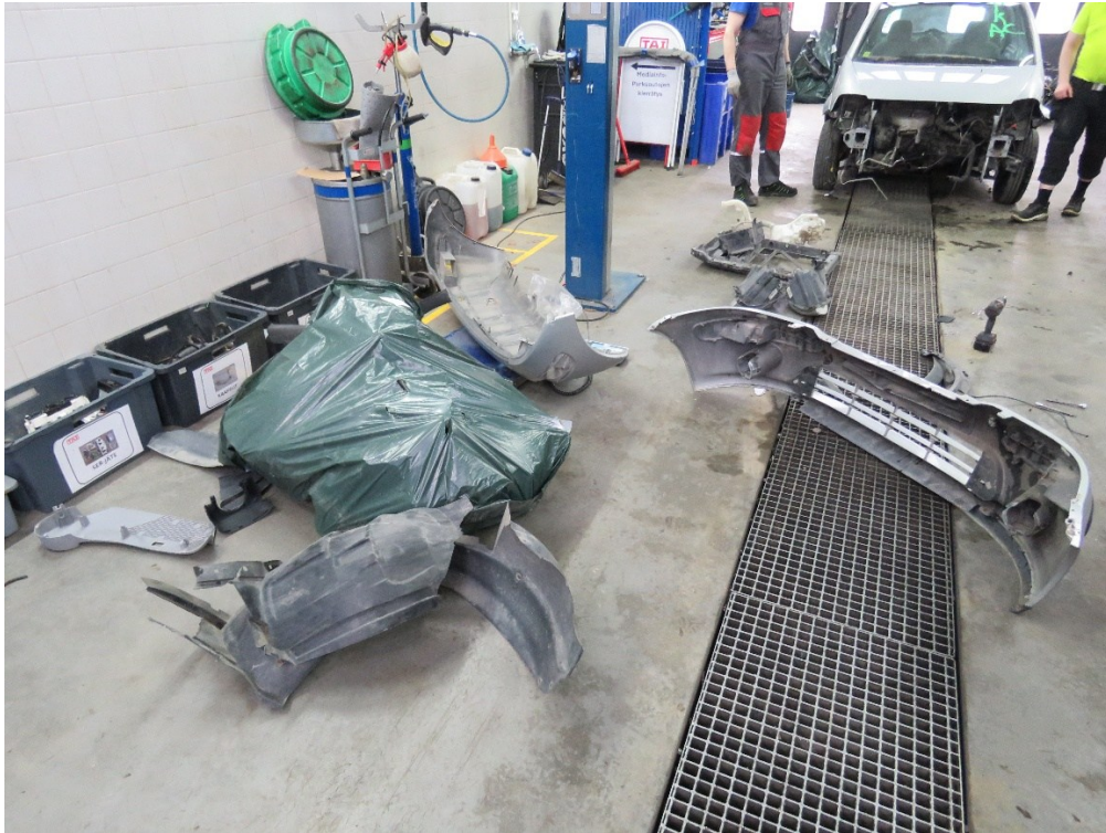
Kuva 2. PE-muovien punnitusta, suuret osat irrallaan, pienemmät punnittiin säkissä.
