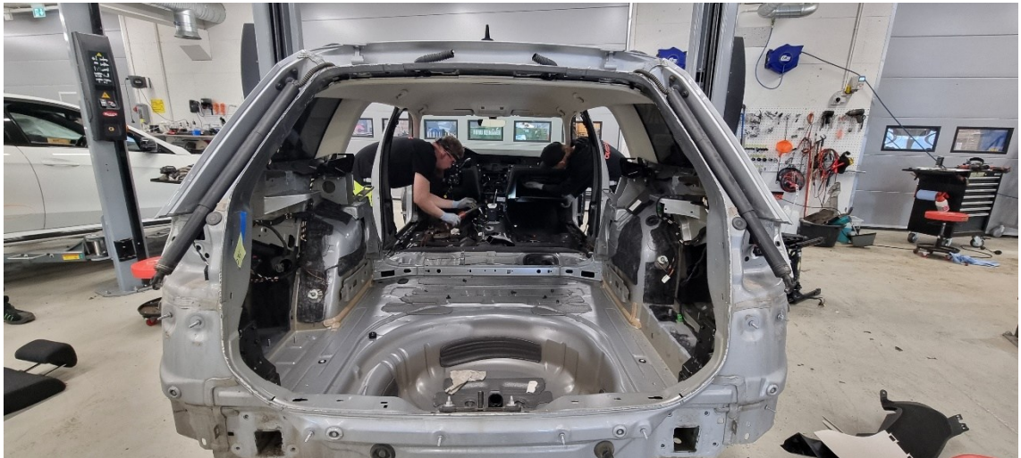
Kuva 16. Kojelaudan ja keskikonsolin työstöä ja sisustan purkamista loppuun.
