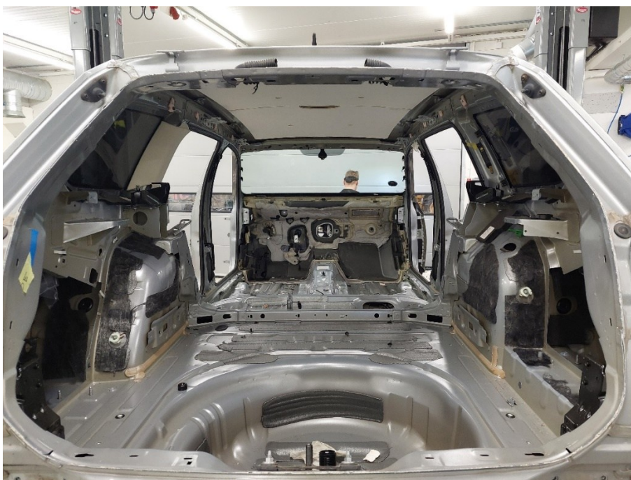
Kuva 19. Sisusta purettu kokonaan.
