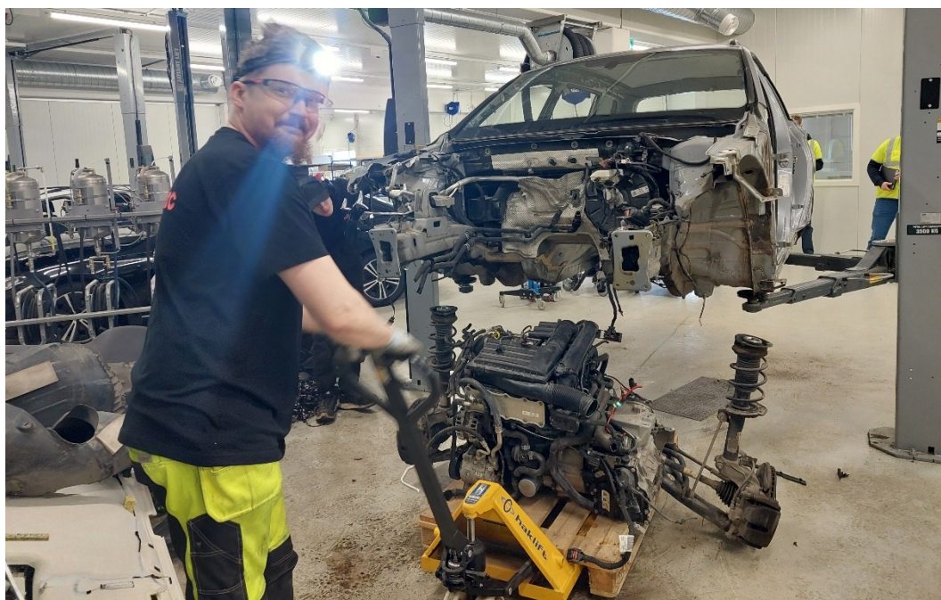
Kuva 22. Voimayksikkö ja etuakseli irrotettu eurolavalle.
