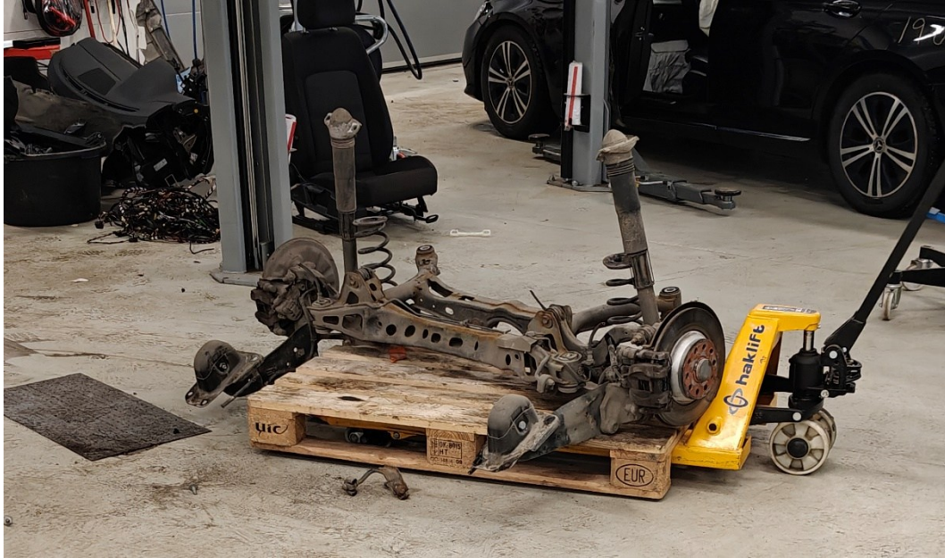
Kuva 23. Taka-akseli irrotettuna eurolavalla.
