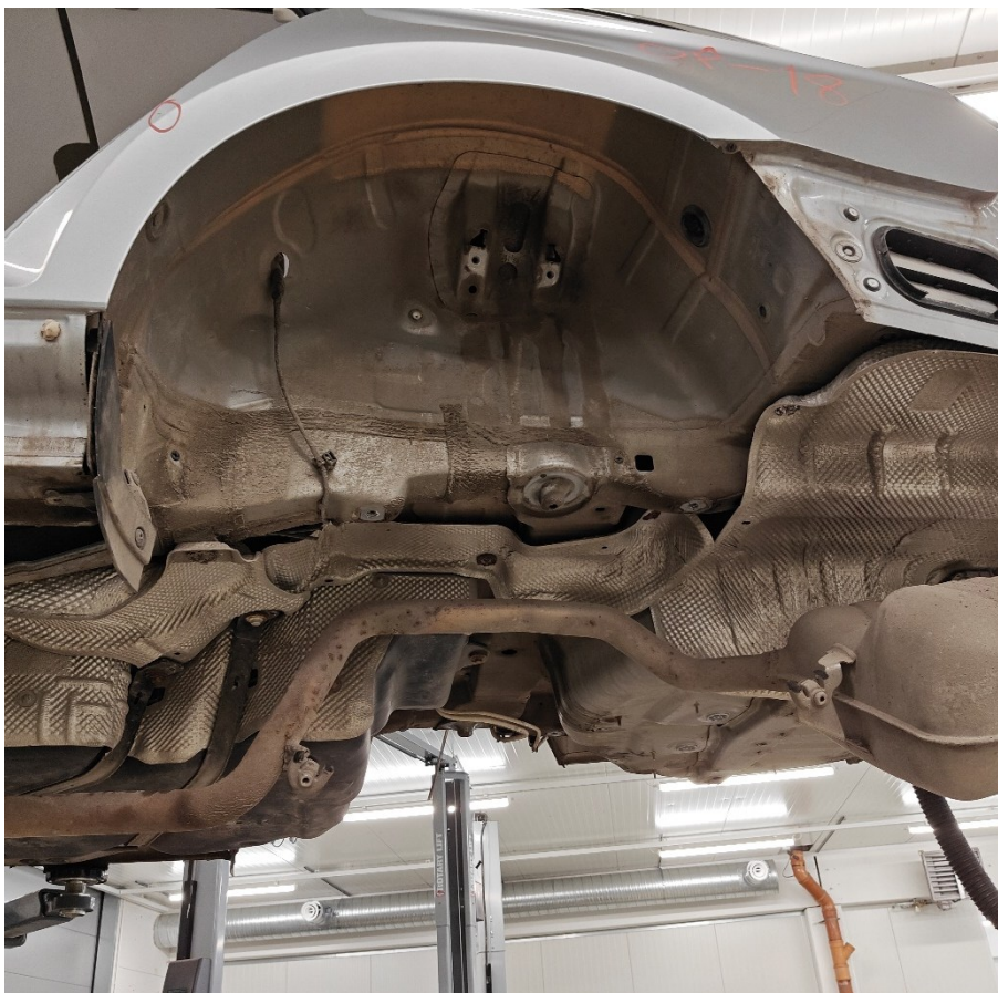
Kuva 27. Polttoainesäiliö poistettu ja pakoputki työn alla.
