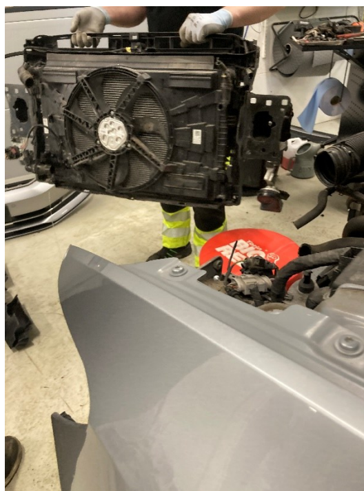
Kuva 10. Takapuskurin irrotus (vas.) ja jäähdyttimen poisto edestä (oik.).
