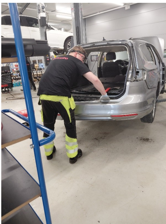
Kuva 10. Takapuskurin irrotus (vas.) ja jäähdyttimen poisto edestä (oik.).
