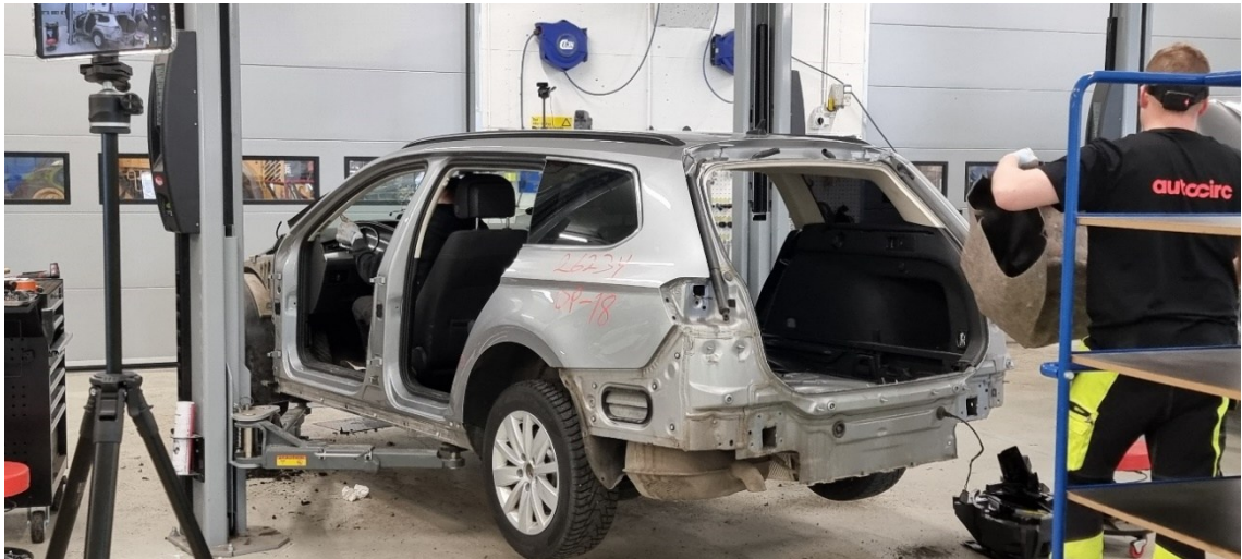
Kuva 14. Tavaratilan sisustan purkua ja kojelaudan työstöä.
