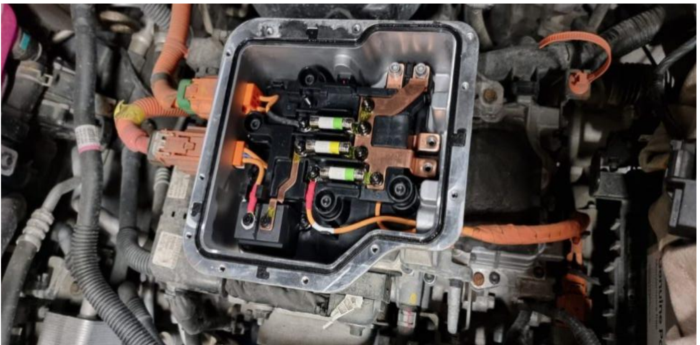
Kuva 2. Korkeajännitekaapelit irrotettiin ensin ajomoottorista.
