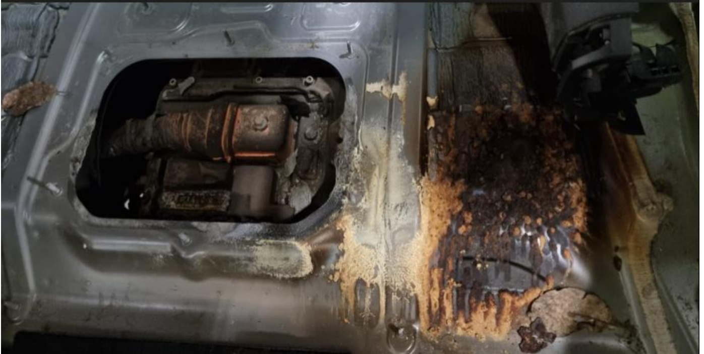
Kuva 3. Paloalue sisältä, takapenkin alla.
