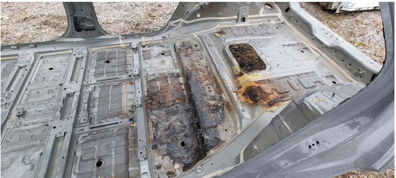
Kuva 4. Purettu sisusta ja paloalue.
