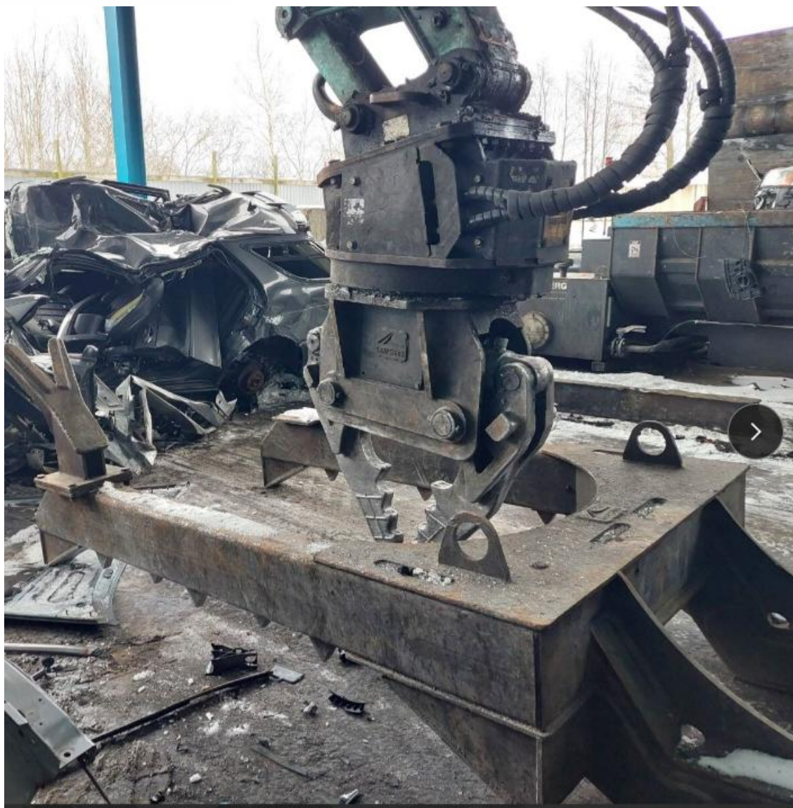
Kuva 3. Tässä kaivurin pinsettikoura, jolla viimeinen purku ennen kuin auto paalataan.
