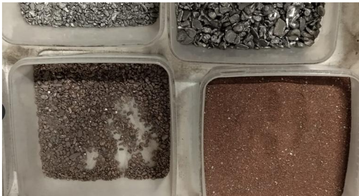
Kuva 9. Mekaanisen käsittelyn jälkeen erilaisia talteen otettavia jakeita.
