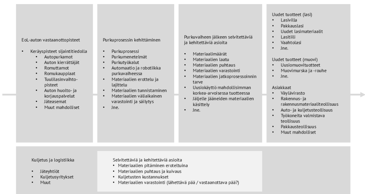
Kuva 2. Autonpurkuprosessin nykytila ja kehittäminen.
