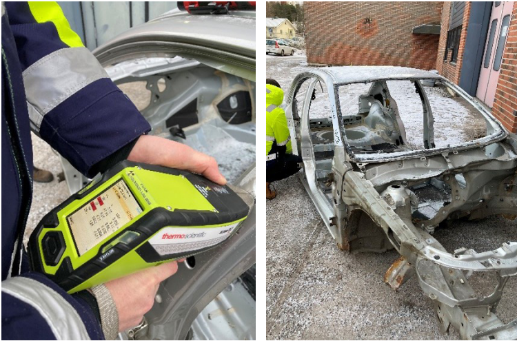
Kuva 12. Stenan Niton XRF-analyssaattorilla tunnistettiin testiin sopivia metalliosia.
